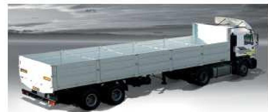
Kapaklar saç veya alüminyum malzemeden... Şasi ve dingiller Karayolu Yönetmeliği'ne ve TSE normlarına uygun. Fren ve elektrik donanımı tüm yönetmeliklere uygun üretiliyor. Kriko ayakları paralel çalışan, çift hızlı, geniş pabuçlu, teleskopik, statik 50 ton, dinamik 25 ton kapasitede... Lastik ve jantlar dingil sayısına, kapasitesine uygun olarak kullanılıyor.
